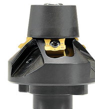
Abb. 45°-Radius-Fräser mit 3 x 2 Schneiden und Führungsrolle, bestückt mit 3 x 3 mm-Radius-Wendeschneidplatten vom Typ R-K
