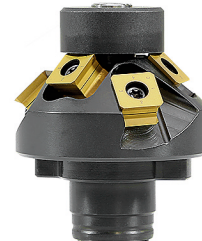
Abb. 45°-Fasen-Fräser mit 3 x 2 Schneiden und Führungsrolle, bestückt mit 6 Fasen-Wendeschneidplatten vom Typ K
